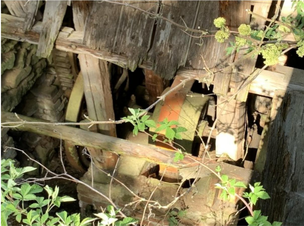
Wasser treibt das Wasserrad an. Mit Hilfe eines Riemens (hier orange) wird die Kraft auf die anderen Räder übertragen.
